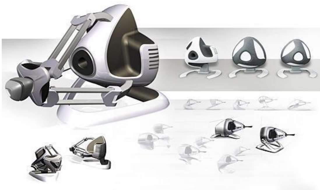
Рисунок 13. Потребительское 3D-гаптическое устройство Novint Falcon Контроллеры
