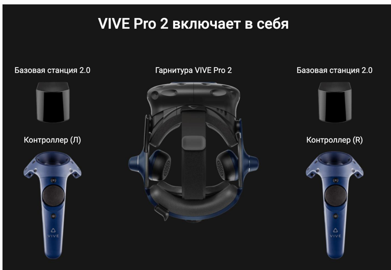
Рисунок 19. Гарнитура виртуальной реальности VIVE Pro 2
