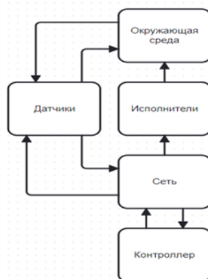
Рис. 14-взаимодействие контроллера с устройствами IoT
