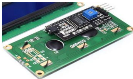
Рис. 26 - Потенциометр на ЖК-дисплее 1602
