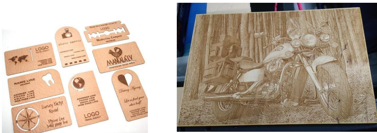
Рисунок 2 - Примеры лазерной гравировки на фанере
