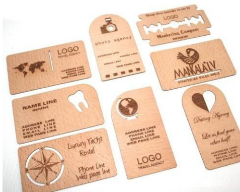
60-сурет-фанердегі лазерлік гравюраның мысалдары
