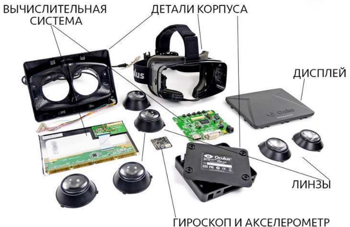
10-сурет. Виртуалды шынайлық гарнитурасының негізгі компоненттері
