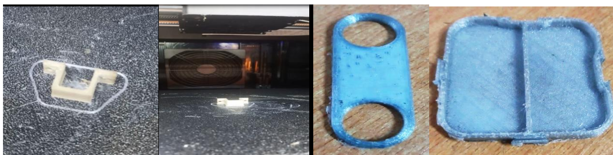
Рисунок 13. Первые детали из переработанной ПЭТ-бутылки
