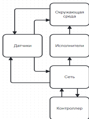
19-сурет - Контроллердің IoT құрылғыларымен өзара әрекеттесуі
