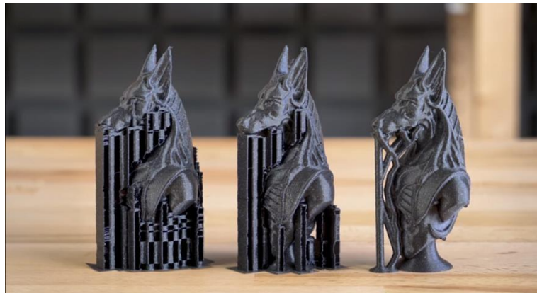
Рис.27 Модель, напечатанная с поддержками
