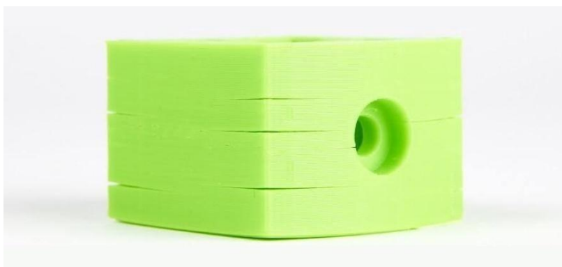
Рис. 20. Деламинация на 3D модели
