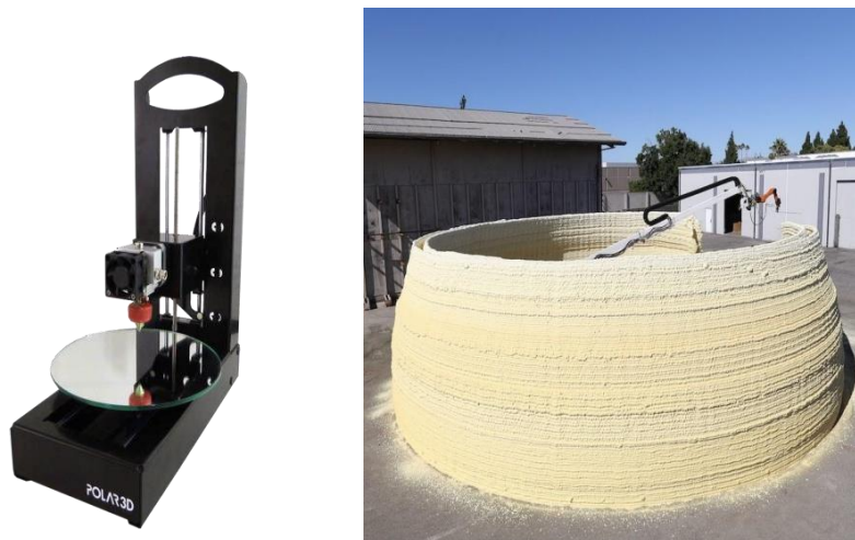
Рис. 5. Принтеры с полярной кинематикой
