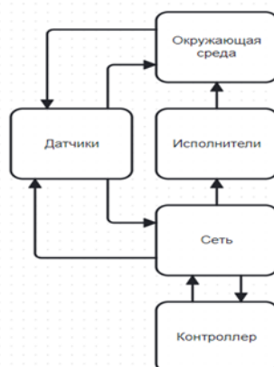
Рис. 49 -Взаимодействие контроллера с устройствами IoT
