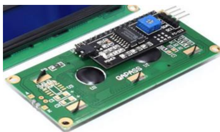
Рис. 63 - Потенциометр на ЖК-дисплее 1602
