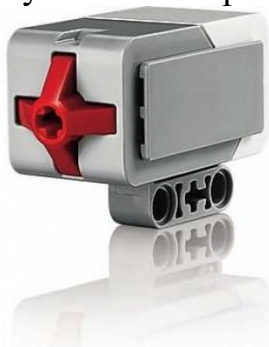
Рисунок 7. Датчик касания в EV3 Mindstorms
