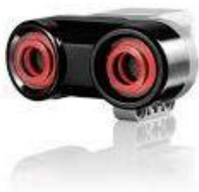
Рисунок 6. Ультразвуковой датчик расстояния в EV3 Mindstorms
