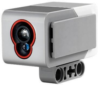
Рисунок 8. Датчик цвета в EV3 Mindstorms
