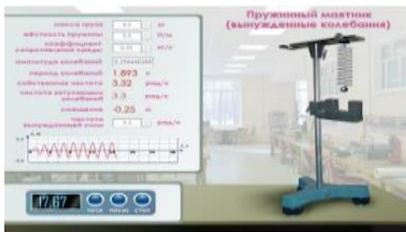
3.6-сурет. Серіппелі маятниктегі өшетін механикалық тербелістерді имитациялайтын виртуалды қондырғы
