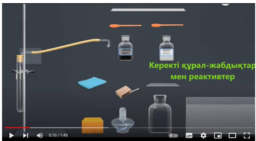
16-сурет – Бертолле тұзын каталитикалық қыздыру арқылы оттегі газын алу
